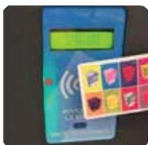
Painel eletrónico com LCD e leitor RFID para controlar o acesso dos utilizadores.
